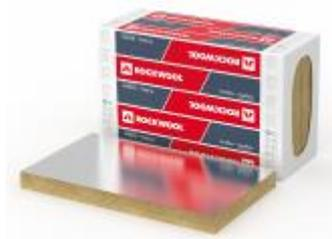
SeaRox SL 740 ALU ist eine halbstarre, widerstandsfähige Steinwolle-Dämmplatte, die einseitig mit gitternetzverstärkter Aluminiumkaschierung versehen ist.
