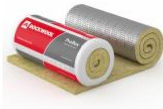
ProRox WM 960 ALU ist eine leicht laminierte Steinwolle-Isoliermatte, die mit verzinktem Draht auf ein verzinktes Drahtgeflecht gesteppt ist, die einseitig mit gitternetzverstärkter Aluminiumkaschierung versehen ist.
