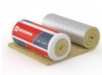
SeaRox WM 640 ALU ist eine Steinwolle-Drahtnetzmatte für schwere Einsatzbedingungen, die mit verzinktem Draht auf ein verzinktes Drahtgeflecht gesteppt ist, die einseitig mit gitternetzverstärkter Aluminiumkaschierung versehen ist.
