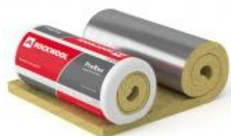
ProRox MA 520 ALU ist eine druckfeste, elastische Steinwolle-Matte höherer Rohdichte mit überwiegend senkrechter Faserstruktur, die einseitig mit reißfester gitternetzverstärkter Aluminiumfolie kaschiert ist.
