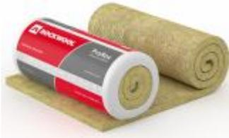
ProRox WM 950 ist eine leicht laminierte Steinwolle-Isoliermatte, die mit verzinktem Draht auf ein verzinktes Drahtgeflecht gesteppt ist. Auf Anfrage sind auch Edelstahl-Steppdraht und Edelstahl-Drahtgeflecht (SW) und/oder gitternetzverstärkte Aluminiumfolie (ALU) lieferbar.
