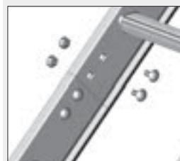
Die Dachleitern werden mit den Verbindungsclashen Art.-Nr. 1049.x03 verbunden. Die Schrauben, Scheiben und Sicherungsmuttern sind im Lieferumfang vorhanden. Es müssen pro Lasche 4 Schrauben verwendet werden. Es können bis zu drei Leitern gestoßen werden, ohne dass zusätzliche Dachhaken verwendet werden.
