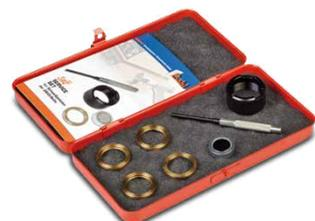
Das **Self-Service-Set** ermöglicht grundlegende Wartungsarbeiten an den Verschleißteilen und besteht aus: 1x Serviceanleitung, 1x Montagestift, 1x Haftmagnet, 1x Isolierhülse, 4x Kontakttring (passend für alle Schweißpistolen der GS-45- und GS-100-Reihe)
