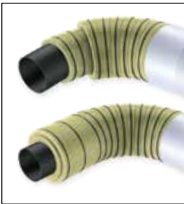
Mehrlagige Anwendung PAROC Pro Segment 100/140, weiterführende Dämmung mit PAROC Pro Lock oder PAROC Multi-Layer-System, der Fugenversatz gewährleistet eine Reduzierung der Wärmeverluste.
