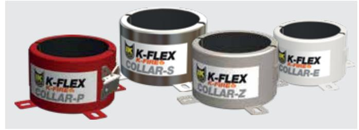
K-FLEX® K-FIRE COLLAR sind Brandschutzmanschetten, die für brennbare Rohre entwickelt wurden. Sie werden um das brennbare Rohr installiert. Unter Brandbedingungen dehnt (schäumt) sich das intumeszierende Material innerhalb der Manschette aus, um das brennbare Rohr zu zerquetschen und die entstehende Öffnung zu verschließen, wodurch die Eigenschaften des Wand- und Deckendurchbruchs für eine bestimmte Feuerwiderstandsfähigkeit und Dämmleitung erhalten bleibt.
