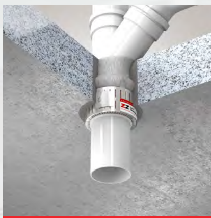
ISITHERM Rohrmanschette NE auf Über- schiebemuffe mit HBT Brandschutzmörtel M3 in Massivdecke eingemörtelt
