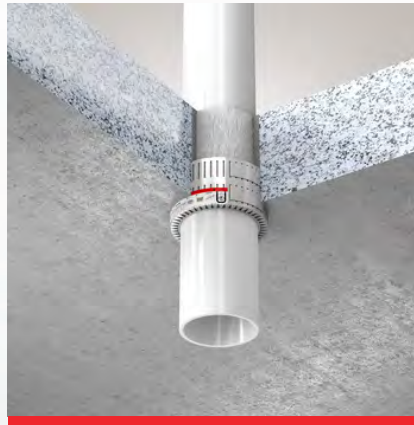
ISITHERM Rohrmanschette BBR in Massiv- decke eingemörtelt mit HBT Brandschutz- mörtel M3
