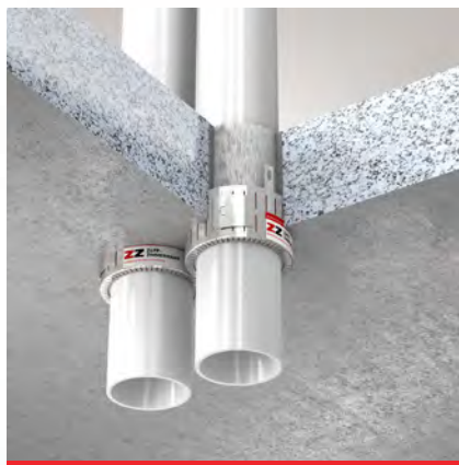
ISITHERM Rohrmanschette NE ohne Abstand mit HBT Brandschutzmörtel M3 in Massivdecke eingemörtelt
