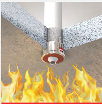
Die intumeszierende Brandschutzeinlage der Rohrmanschette expandiert und drückt das Kunststoffrohr zusammen.
