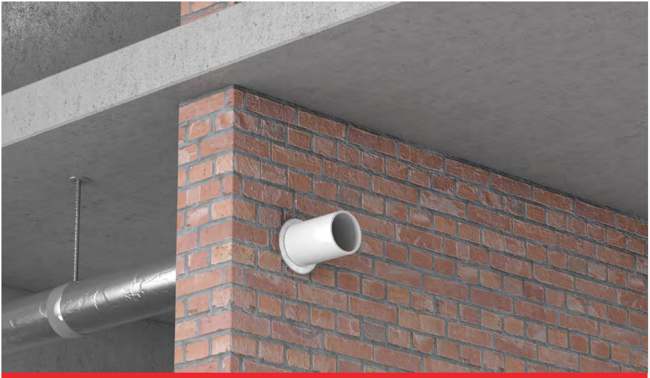
Durchführung von brennbaren Rohren nach Abschnitt 4.3 MLAR
