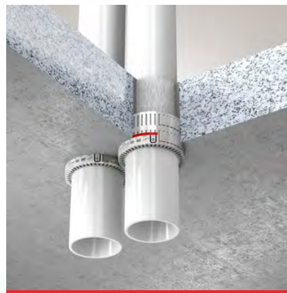
ISITHERM Rohrmanschette BBR mit Nullabstand in Massivdecke mit HBT Brandschutzmörtel M3 eingemörtelt
