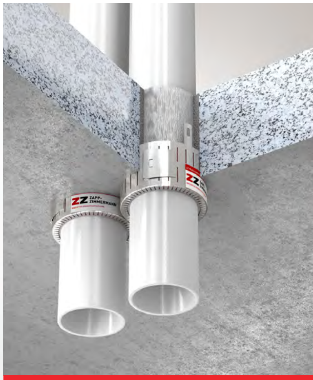
ISITHERM Rohrmanschette NE in Massivdecke
