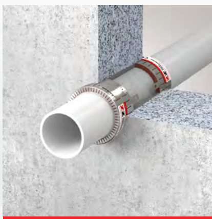
ISITHERM Rohrmanschetten NE beidseitig mit HBT Brandschutzmörtel M3 in Massiv- wand eingemörtelt
