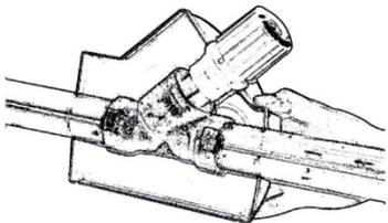
**2.** Zunächst wird eine leere Kappenhälfte derart zur Armatur gehalten, dass die Lage des Armaturenkörpers in der Isolierkappe erkennbar ist.
