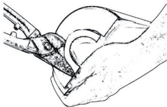
**4.** Die markierten Ausschnitte sowie eventuell notwendige Vergrößerungen der Öffnungen für Rohraustritt oder Spindelhals der Armatur werden am besten mit einer Bleischere (IDEAL- oder Lochschere) ausgeführt.
