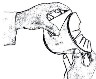
**10.** Die mit Dämmstoff gefüllten Kappenhälften werden an der Armatur derart zusammengeführt, dass die Kappenteile bis zum vorgesehenen Anstoss über-lappen. Mit Hilfe der mitgelieferten Stahldrahtklammern, die in den vorgesehenen Rillen rutsicher liegen sollen, werden die Kappenhälften befestigt.
