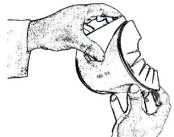
**5.** Seitliche Aussparungen für Entleerungshähne, die abgestuft im Kappenmantel vorgegeben sind, werden am einfachsten mit Hilfe eines feinzahnigen Sägeblattes geöffnet. Die konische Einsatzkappe für den Entleerungshahn wird in der Kappe nach aussen durchgeschoben, wodurch diese im Kappenmantel festklemmt. Die Einsatzkappe kann mit Kunststoffkleber oder PVC-Schweissmittel dauerhaft befestigt werden.
