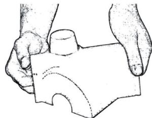
**10.** Die mit Dämmstoff gefüllten Kappenhälften werden an der Armatur derart zusammengeführt, dass die Kappenteile bis zum vorgesehenen Anstoss überlappen. Mit Hilfe der mitgelieferten Stahldrahtklammern, die in den vorgesehenen Rillen rutschsicher liegen sollen, werden die Kappenhälften befestigt.
