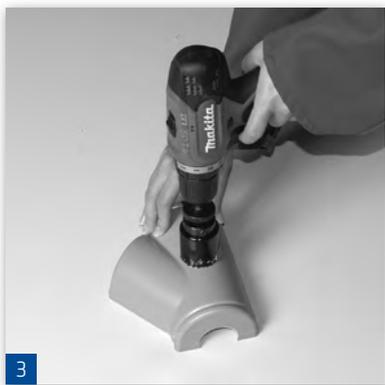
Sägen Sie das Loch für die Entleerung mit einer Lochsäge aus. Tipp: Lassen Sie die Säge links herum laufen, damit der Kunststoff nicht einreißt. Passen Sie den Durchmesser an den zur Verfügung stehenden Adapter an.
