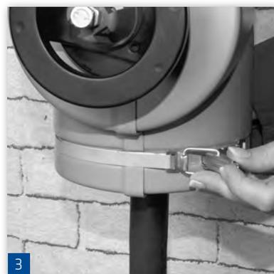
Haken Sie den Spannverschluss in den entsprechenden Bügel und klappen Sie die Lasche um.
