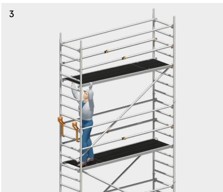
Diagonalen und Durchstiegsbrücke einsetzen.
