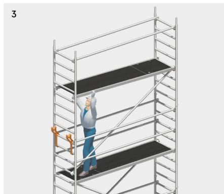
Diagonalen und Durchstiegsbrücke einsetzen.
