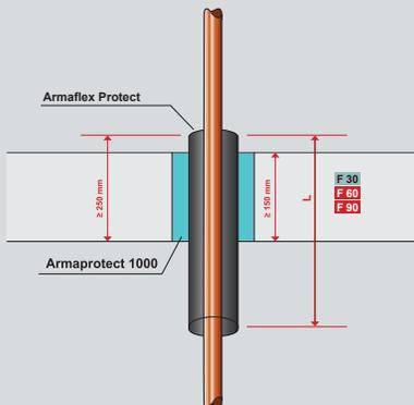
Wenn keine Isolierung über der Decke erforderlich oder möglich ist, kann Armaflex Protect auch unter der Decke installiert werden. Auf diesen Weg können beispielsweise Heizkörperanbindungen einfach und sicher verschlossen werden.
