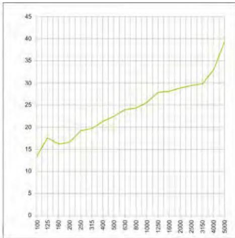
X-Achse = Frequenzen (Hz) Y-Achse = Schalldämmmaß (dB)
