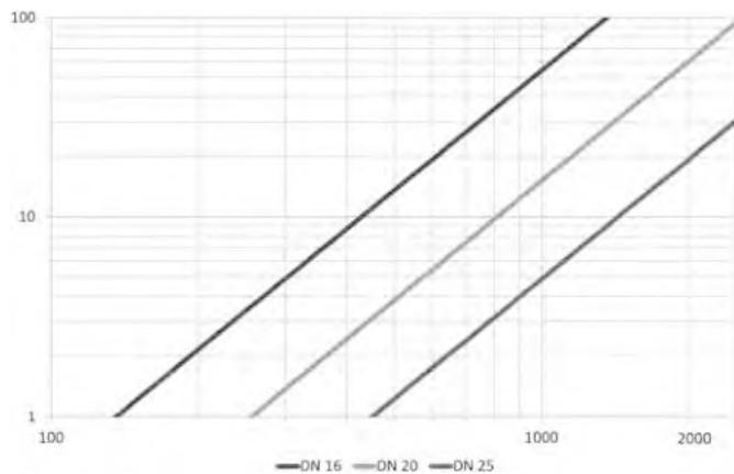
Betriebstemperatur 60 °C, Wärmeträgerflüssigkeit 1,2 Propylenglykol,
