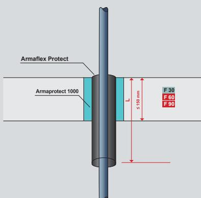
Montage bei Kunststoffrohren.
