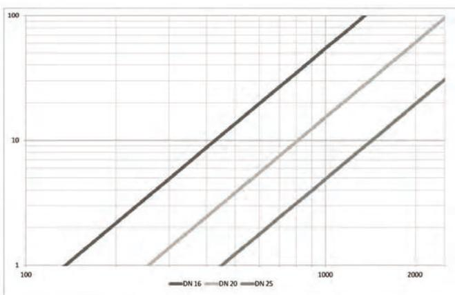
Betriebstemperatur 60 °C, Wärmeträgerflüssigkeit 1,2 Propylenglykol,
