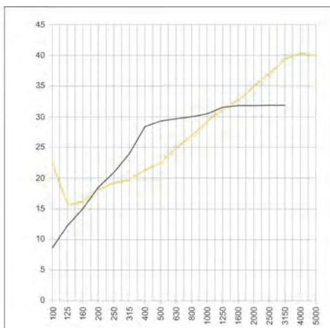
X-Achse = Freq. (Hz) Y-Achse = Schalldämmmaß (dB)
