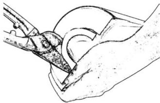
**4.** Die markierten Ausschnitte sowie eventuell notwendige Vergrößerungen der Öffnungen für Rohraustritt oder Spindelhals der Armatur werden am besten mit einer Blechschere (IDEAL- oder Lochschere) ausgeführt.
