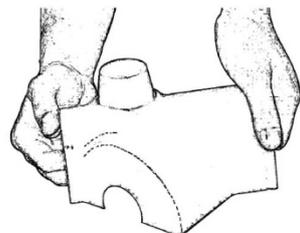
**6.** Als Isoliereinlage für **Wärmedämmungen** sollte eine Mineralfaser (lose oder aus einer Matte geschnitten) gewählt werden, die sich ganz dem Armaturenkörper anpasst. Die Einlage sollte die Kappe satt, ohne Hohlräume, ausfüllen. Sie kann auch eingeklebt werden.
