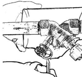
dann wird der Kautschukmantel für den Armaturenkörper abgemessen, zugeschnitten und ebenfalls in die Kappenschale geklemmt, wobei die Verbindung zu den Stirnflächen mit Kautschukkleber lückenlos ausgeführt werden soll. Auf gleiche Weise ist der Armaturenkörper zur Spindel zu dämmen. Wegen der Demontierbarkeit der Armaturenkappe müssen alle Zellkautschukteile „press“
