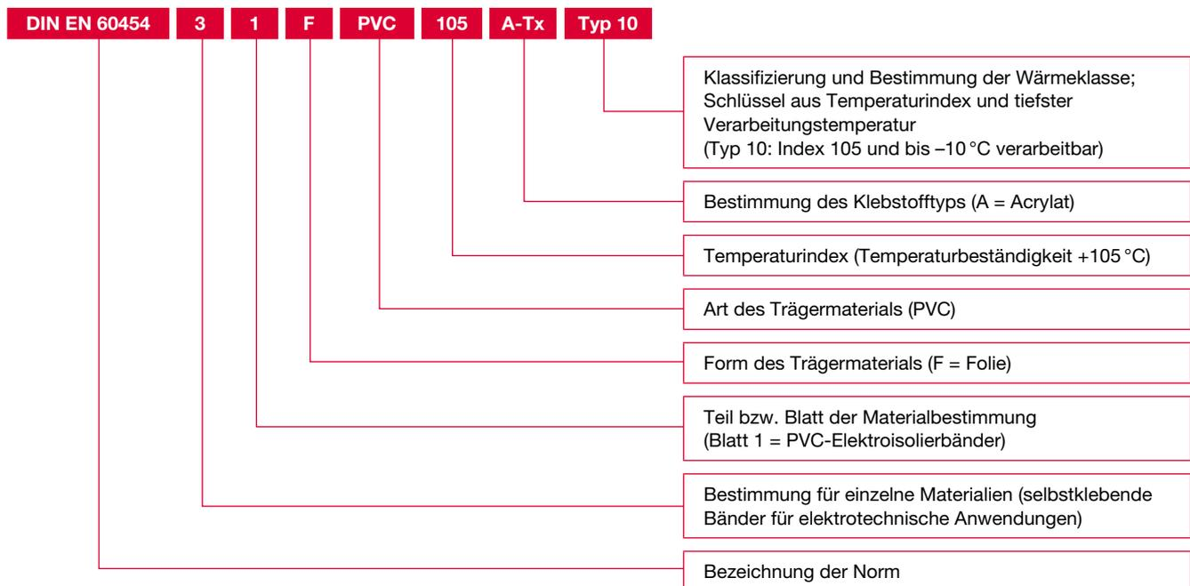
Bereits beim Standardprodukt Coroplast 302 werden die hervorragenden Temperatureigenschaften von Coroplast Klebebändern deutlich: Die verhältnismäßig hohe Wärmeklasse 10 (von 12 möglichen Klassen) wird nach DIN EN 60454-3-1 erreicht (verarbeitbar bis -10 °C, beständig bis +105 °C). Die Coroplast Typen 301 und 302
